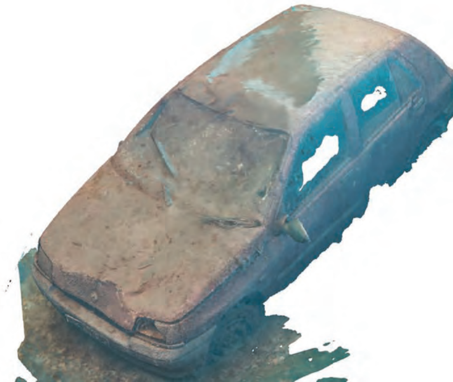
Figure 2: Modélisation tridimensionnelle d'un véhicule par Phidias, à partir de photographies sous-marines acquises par Gérard Yohan, technicien en Identification Sous-Marine, Antibes
